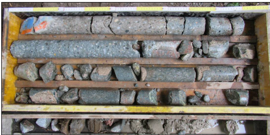
Obr. č. 2 - diagnostický vrt Š1 do opěry Adamov
