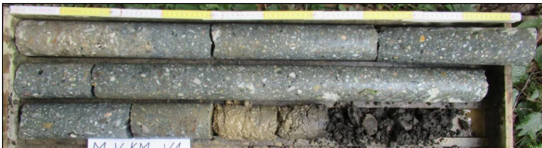
Obr. č. 1 - diagnostický vrt V1 do opěry Adamov
