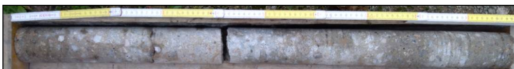
Obr. č. 4 - diagnostický návrt N11 do levého čela NK
