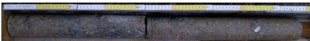
Obr. č. 5 - diagnostický návrť N12 do pravého čela NK
